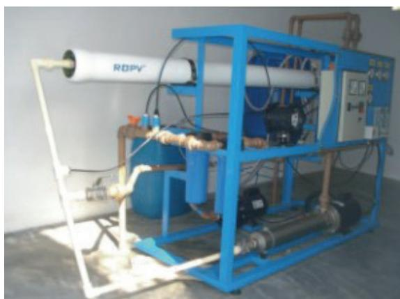
Equipamento eletromecânico e hidráulico responsável por processos físico-químicos como a osmose reversa (retirada de sal da água e outros minerais). A máquina é utilizada para produzir uma água potável de qualidade. Pode ser implantado em escolas públicas, hospitais, creches e comunidades difusas.
