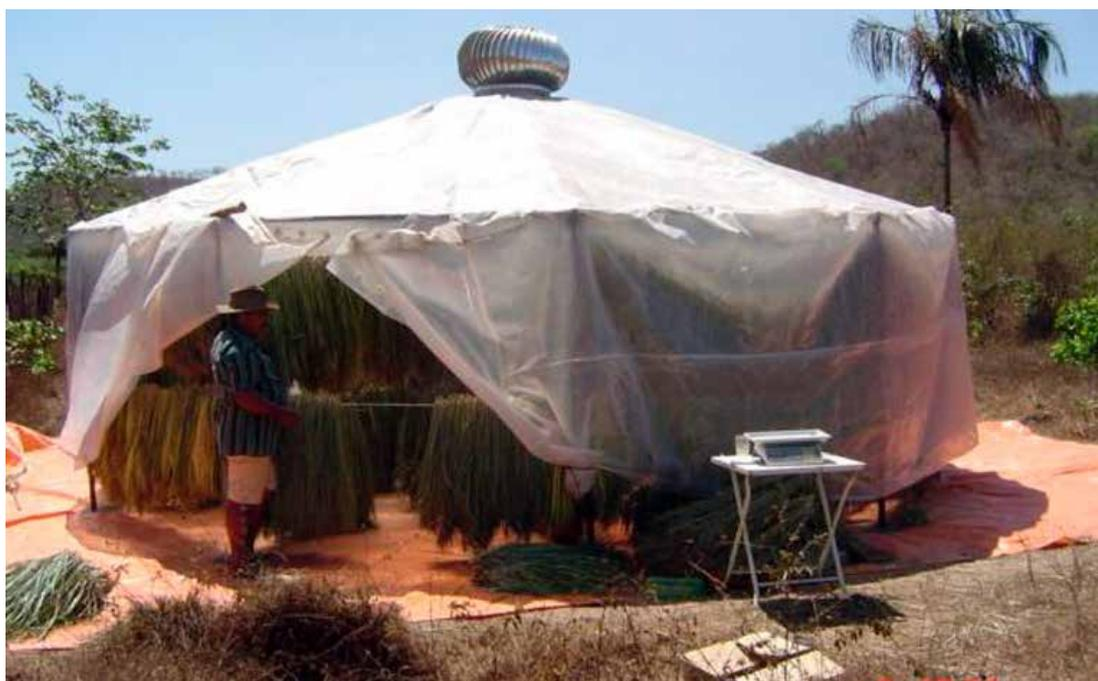
**SÍNTESE DA EXPERIÊNCIA:** As técnicas e processos utilizados para o êxito dessa experimentação foram demonstrados inicialmente pelo uso de um “Secador Solar fixo”. Posteriormente, foi usado um secador de palhas desmontável portátil, que atendeu à demanda de palhas em áreas menores e evitou perdas de pó no transporte por ação do vento. O equipamento aumentou o rendimento do pó extraído e a secagem mais rápida da palha. Isto trouxe uma enorme contribuição à cadeia produtiva de cera de Carnaúba.
