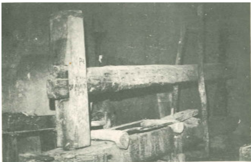
A prensa de massa para farinha de mandioca, instalada pelo Cel. Almeida, no "Sítio Monte" (1860) ainda em funcionamento.
