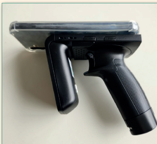
Figura 30 - Coletor Blue Bird adaptado com celular acoplado.
