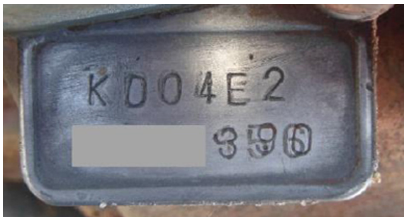
Figura 30: identificação de adulteração veicular após tratamento químico.
