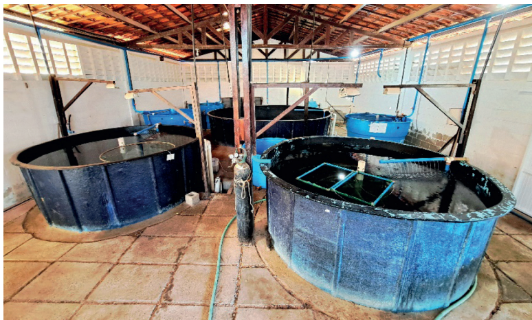
Figura 1. Imagem dos tanques que integram o Sistema de Recirculação de Água (SRA) da UPMAR/LABOMAR/UFC. Foto: Viviana Lisboa.
